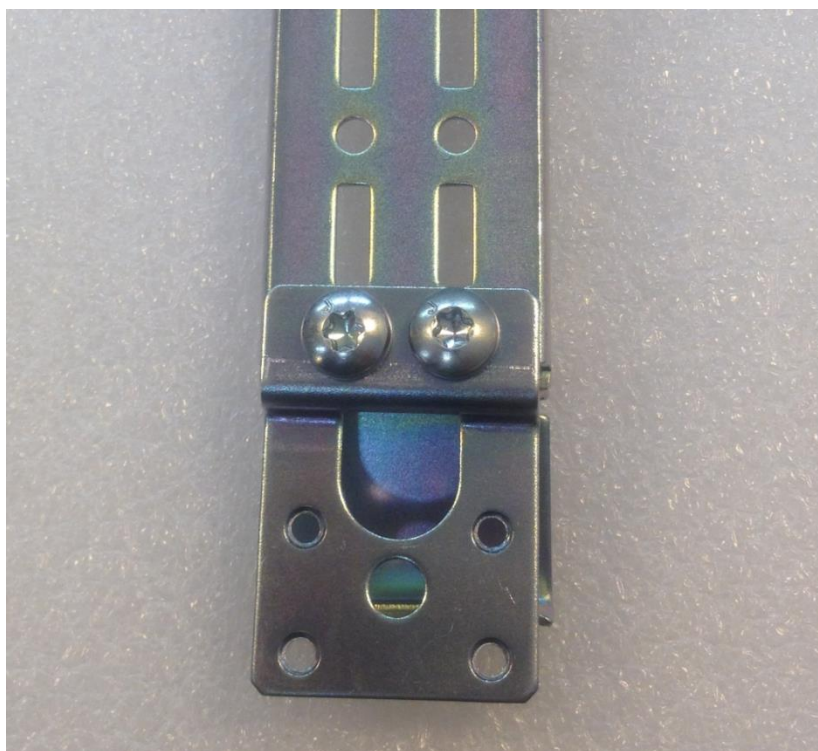
Рис.3.2.8-1 Присоединение удлинителя к шине внутреннего монтажа
