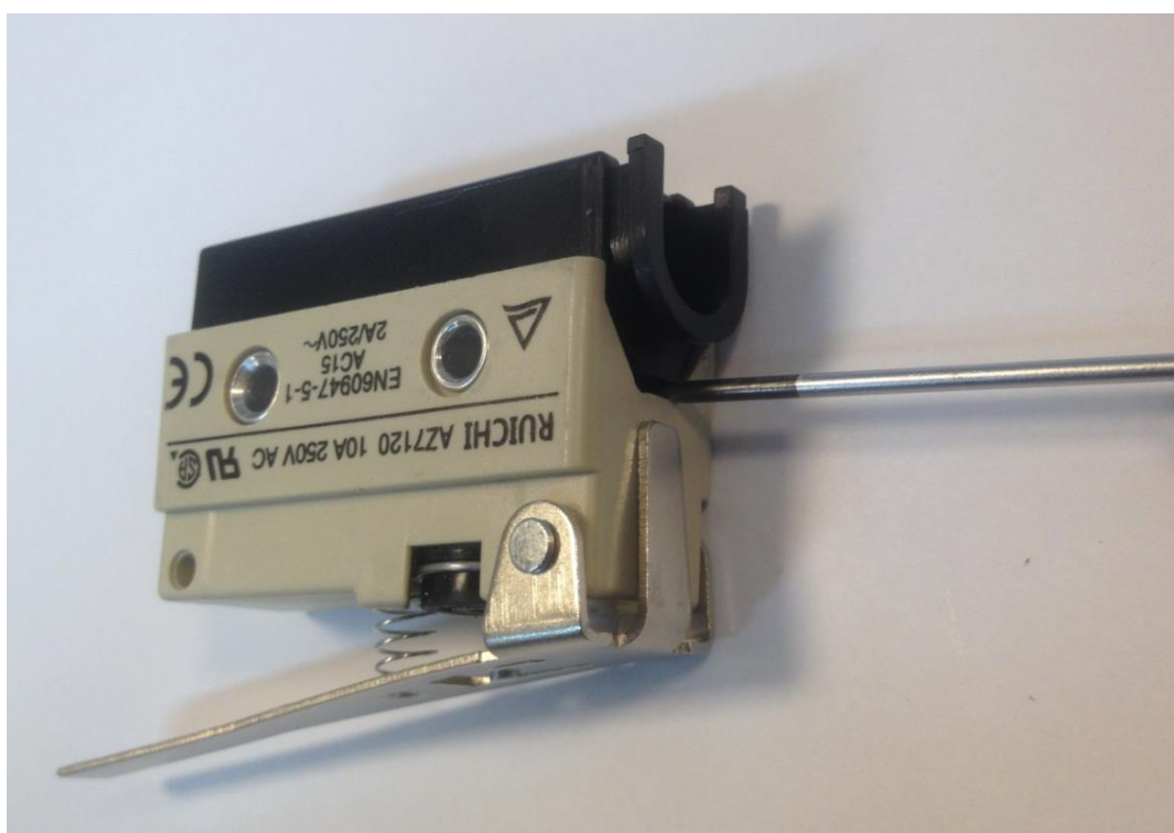
Рис.3.1.3-2 Снятие крышки выключателя
