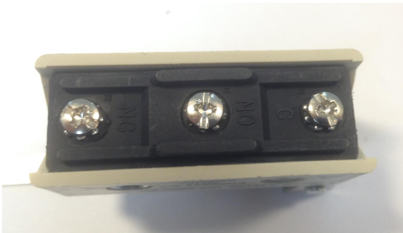
Рис.3.1.5-1 Контакты Датчика вскрытия
