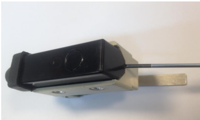
Рис.3.1 Снятие крышки выключателя
