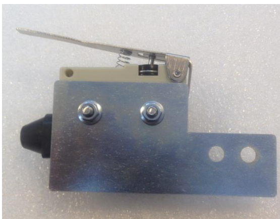
Рис.3.7б Присоединение датчика вскрытия к монтажной панели
