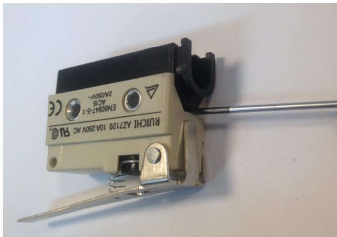
Рис.3.2 Снятие крышки выключателя
