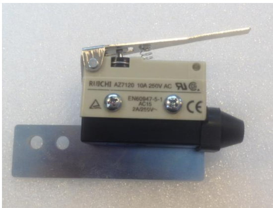
Рис.3.7а Присоединение датчика вскрытия к монтажной панели
