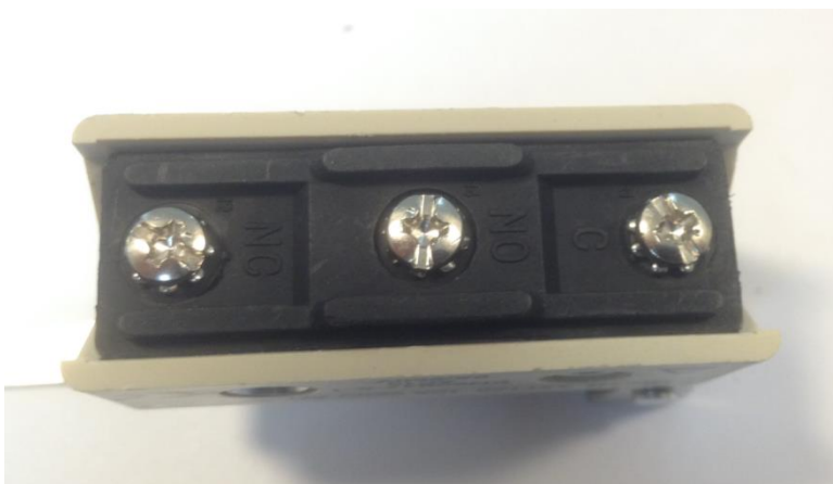
Рис.3.4 Контакты Датчика вскрытия
