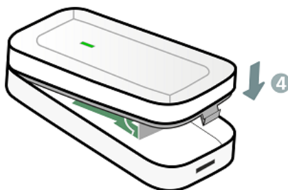
Рисунок 8.4 — Закрытие корпуса радиоустройства
