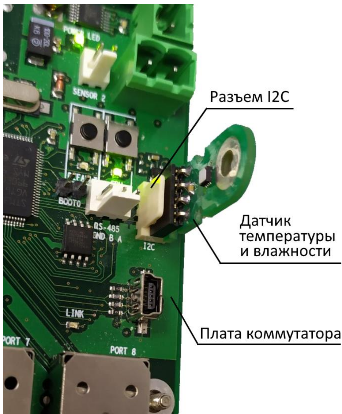
Рис. 4 Установка датчика на плату коммутатора.
