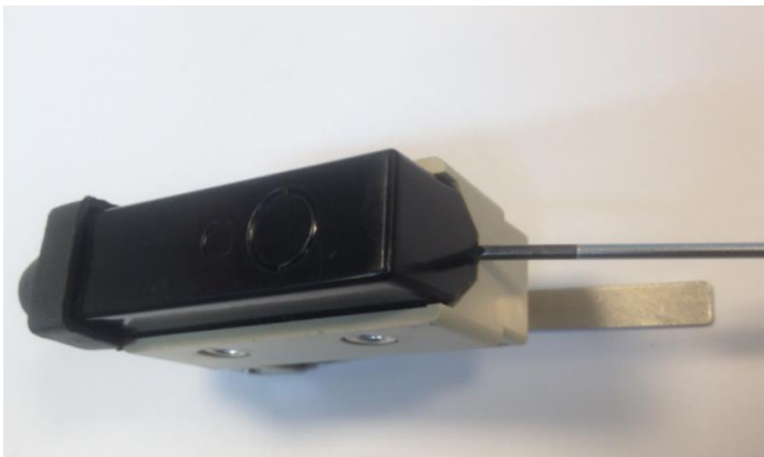
Рис.3.1 Снятие крышки выключателя
