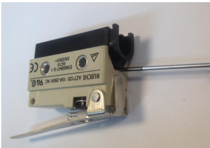
Рис.3.2 Снятие крышки выключателя
