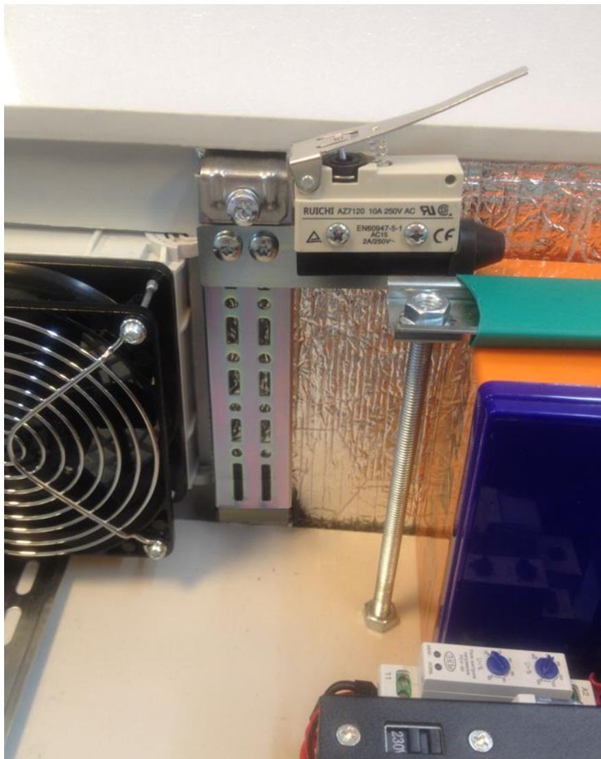
Рис.3.9 Установленная шина внутреннего монтажа с датчиком вскрытия
