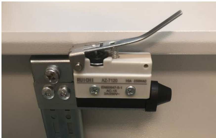
Рис.3.10. Регулировка металлического коромысла датчика
