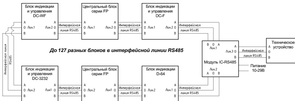
Рис. 2. Схема подключения БИУ серии DC-F.
