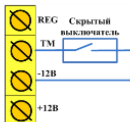
Рисунок 3.2 — Схема подключения скрытого выключателя
