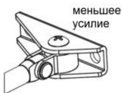
Рисунок 5 – Регулирование усилия закрытия путем ориентации башмака
