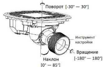
Рисунок 1-25 Настройка угла наблюдения камеры
