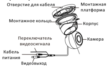
Рисунок 1-20 Камера «шар» V типа
