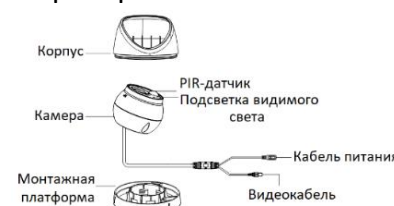
Рисунок 1-18 Камера «шар» III типа
