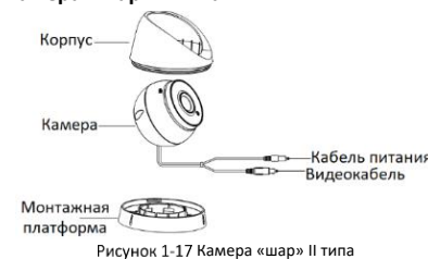
Рисунок 1-17 Камера «шар» II типа
