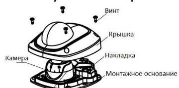
Рисунок 1-23 Настройка угла наблюдения камеры
