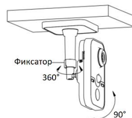
Рисунок 1-27 Настройка угла наблюдения камеры
