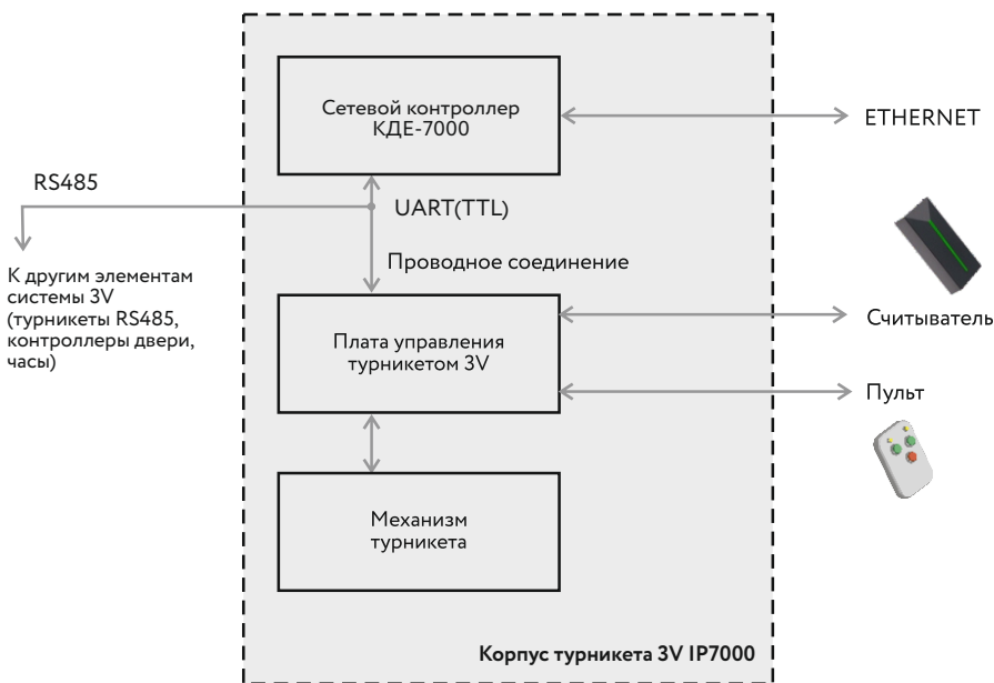
Рисунок 2.3 – Структура турникета IP7000
