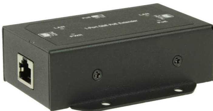
Рис.1 Удлинители E-PoE/1G(90W), E-PoE/2G(90W), внешний вид
