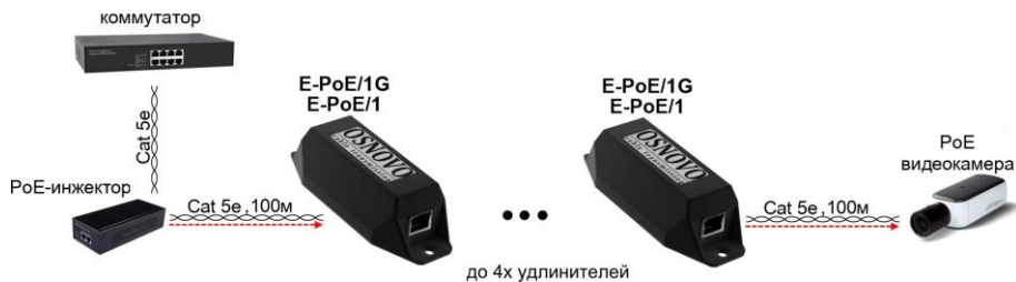
Рис. 6 Схема подключения удлинителей на примере модели E-PoE/1, E-PoE/1G
