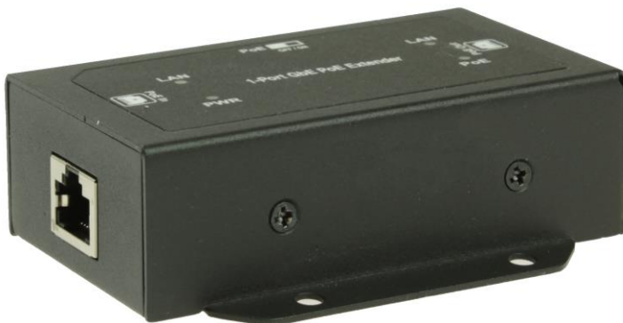
Рис.1 Удлинители E-PoE/1G(90W), E-PoE/2G(90W), внешний вид
