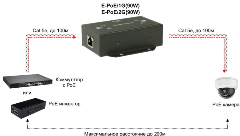
Рис.4 Схема подключения PoE удлинителей E-PoE/1G(90W), E-PoE/2G(90W)
