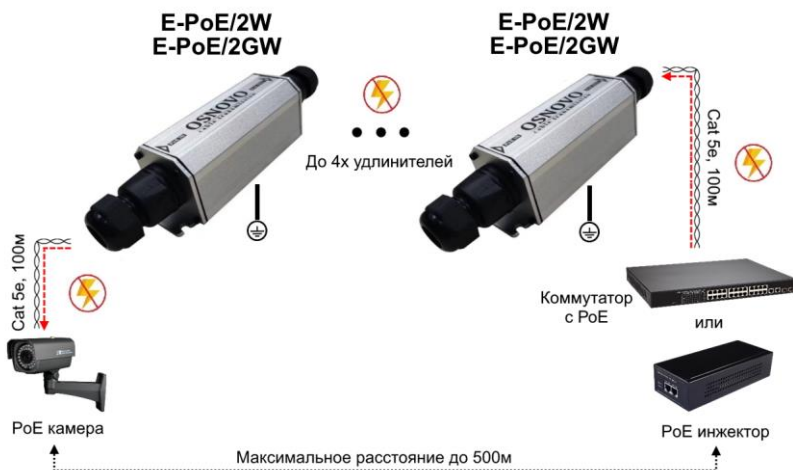
Рис.3 Схема подключения удлинителей E-PoE/2W, E-PoE/2GW
