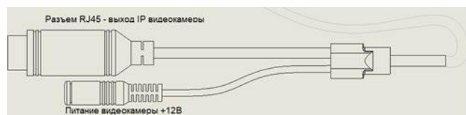
Рис.3 Назначение разъемов видеокамеры EVM2-IPx-M/KP25 (для п/п 1-3 см. таблицу исполнений)
