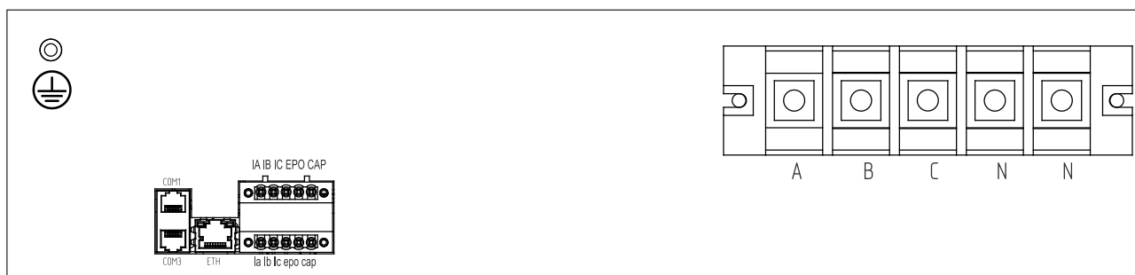
Рисунок 2.5 — Конфигурация клемм и разъемов OptiSine A-75K-37A и OptiSine A100K-50A
