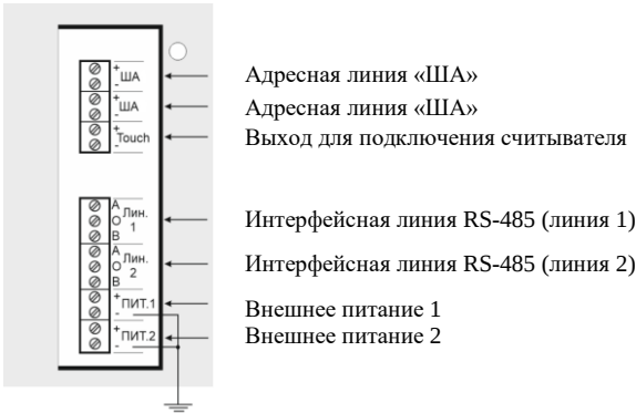
Рис. 1. Схема подключения ЦБ
