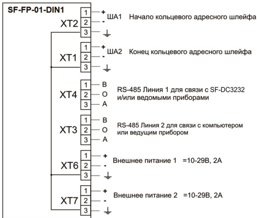
Схема подключения SF-FP-01-DIN исп.1
