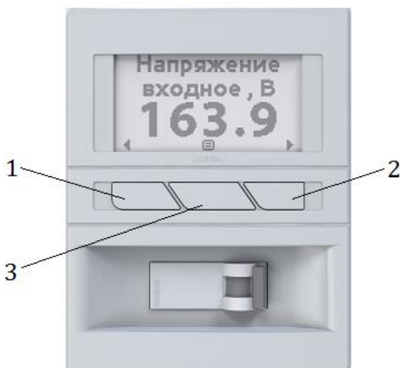
Рисунок 12. Расположение кнопок управления на панели управления
