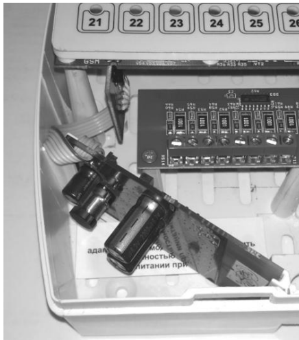
Рис. 3. Установка и подключение модуля SMS
