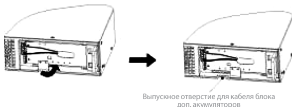
Рис. 9 Снятие направляющих для кабеля
