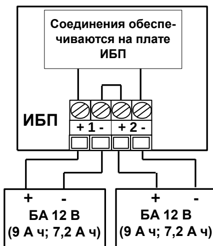
Рис. 6 Подключение аккумуляторных батарей в ИБП-24 к разъему ХТ2
