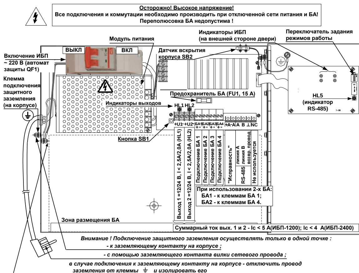
Рис. 3 Внешний вид ИБП-1200/2400 исп. 1 с открытой дверью
