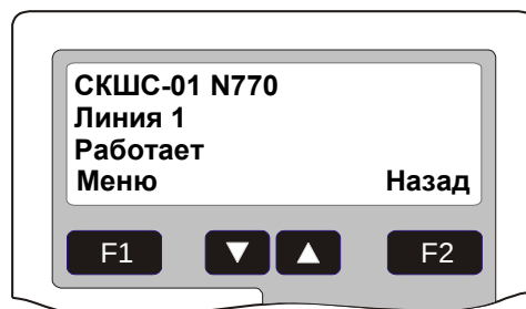
Рис. 15 Состояние работоспособности ПСФ
