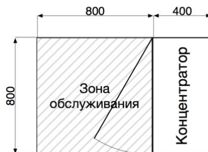
Рис. 2 Зоны обслуживания концентратора с одностворчатой дверью
