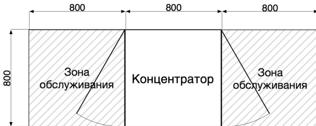
Рис. 2 Зоны обслуживания концентратора с одностворчатыми дверями
