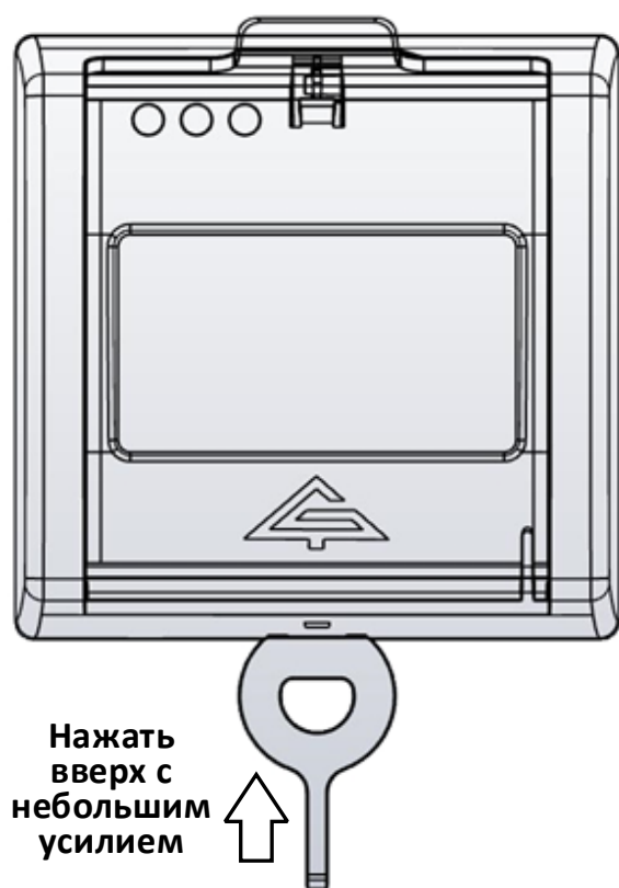
Снятие корпуса ИПР-И.
