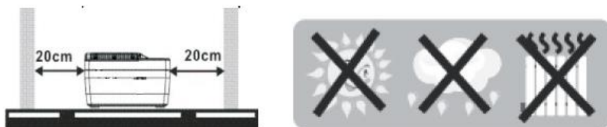
Figure 1. Posizionamento dell' UPS
