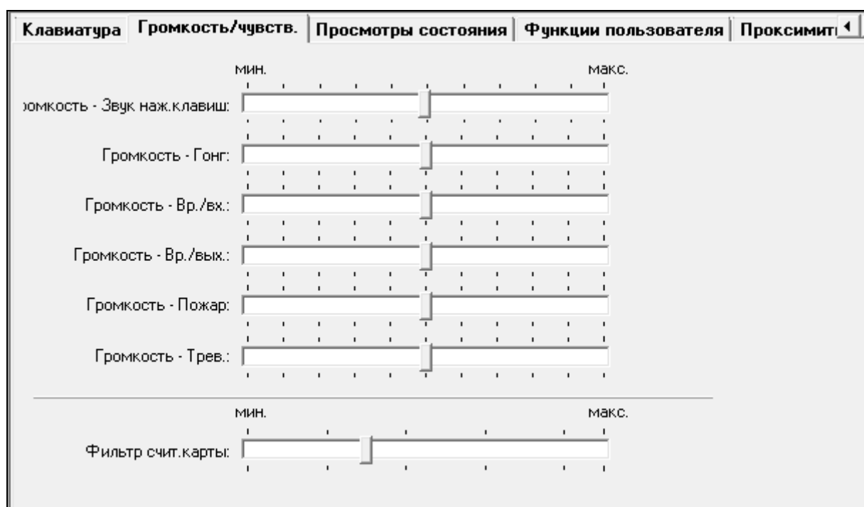
Рис. 6. Программа DLOADX: установки клавиатуры, хранящиеся в приемно-контрольном приборе – закладка "Громкость/чувствительность".
