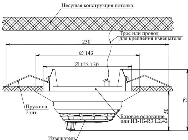
Рисунок А.2 – Установка извещателя на подвесном потолке с базовыми основаниями W2.02, W2.03 или ИЗ-1Б-Р3 L2.42
