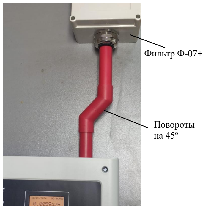
Рисунок 3 – Подключение фильтра Ф-07+ с двумя поворотами на 45°
