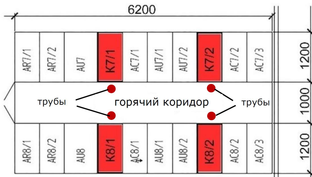
Рисунок 25 – Размещение труб с воздухозаборными отверстиями на входах межстоечных кондиционеров в «горячем» коридоре
