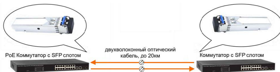
Рисунок 5 - Схема подключения для «комплекта SFP модулей»
