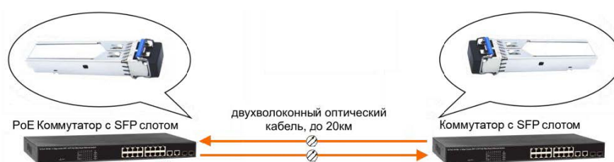
Рисунок 5 - Схема подключения комплекта SFP модулей
