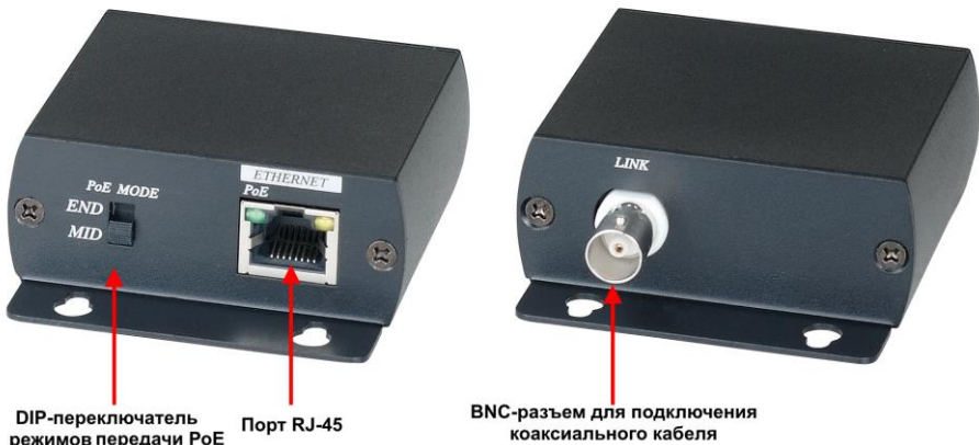
Рис. 2 Приемопередатчик IP01P, расположение разъемов
