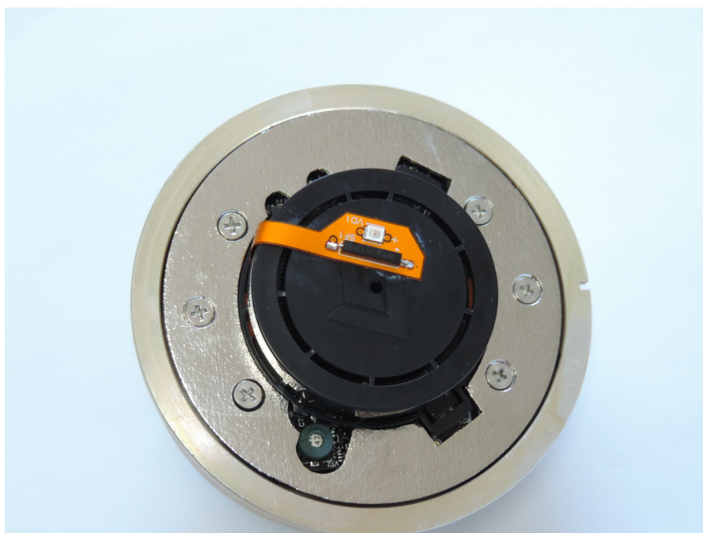
Рисунок А.4 – Вид измерительного блока (фланца) сверху. На дымовой камере расположена гибкая плата со светодиодами и герконом для адресации прибора
