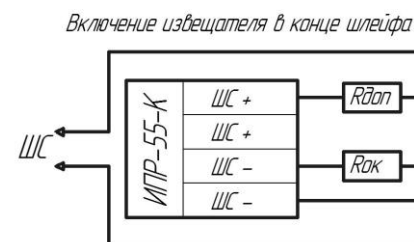
Рисунок 2. Включение извещателя в конце шлейфа
