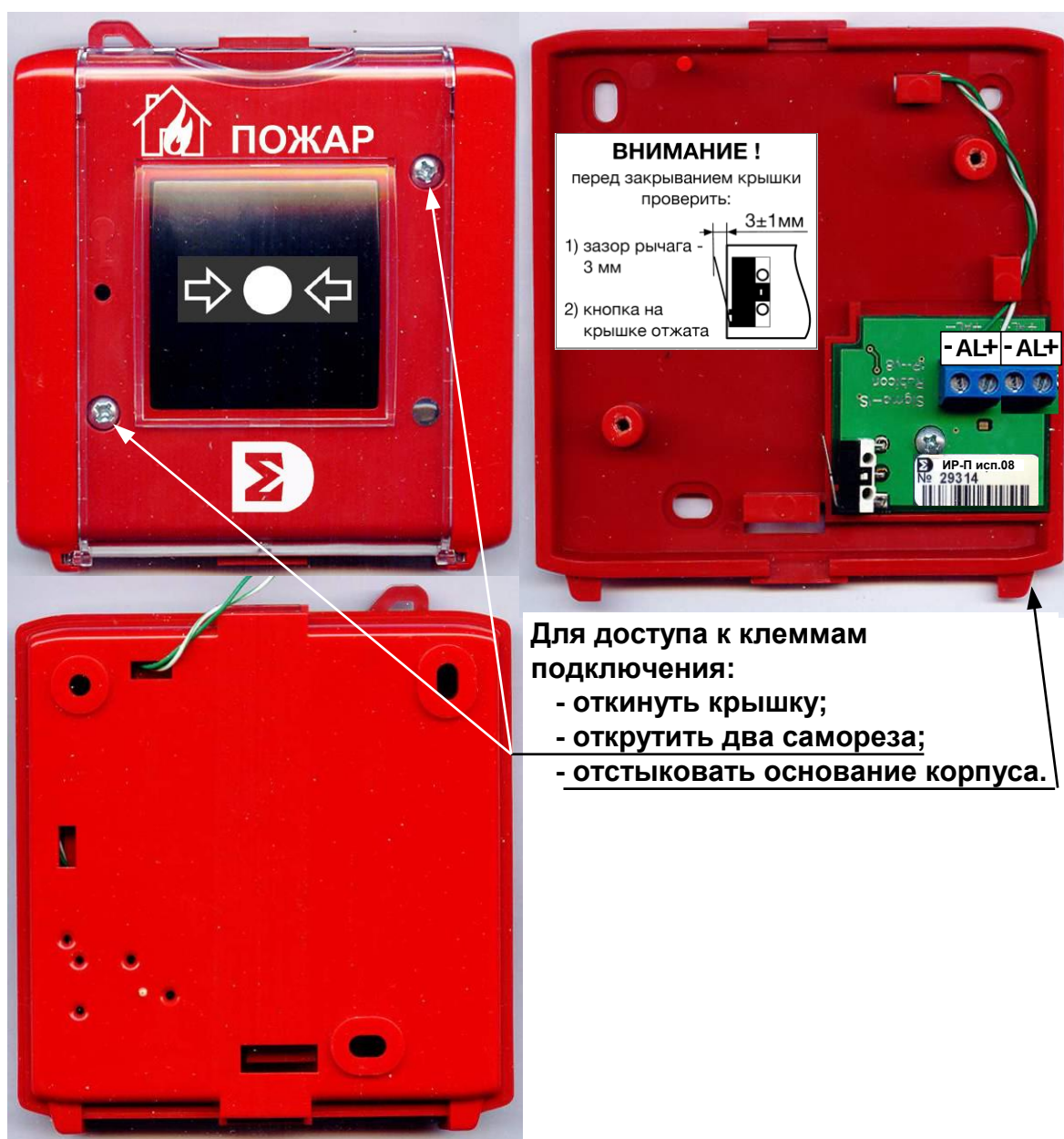
Рис. 2 ИР-П. Внешний вид, клеммы подключения.
