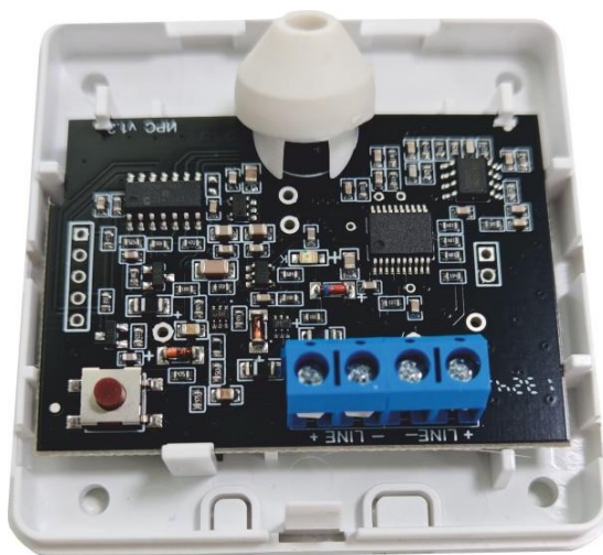
Рис. 2 ИРС исп.08. Основание корпуса с платой
