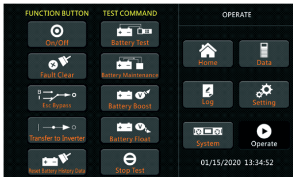
Рисунок 26 – Раздел меню информации о системе (Operate)
