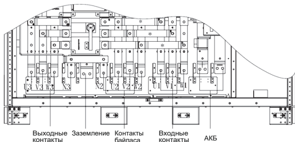
Рисунок 22 – Шина с клеммами для моделей 250–300 кВА
