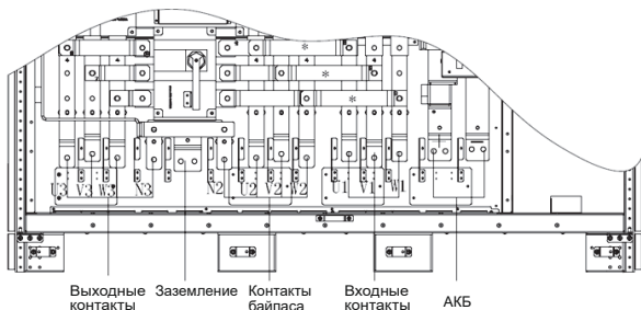
Рисунок 22 – Шина с клеммами для моделей 250–300 кВА
