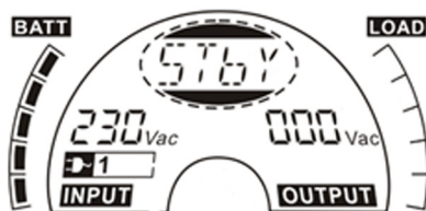
Рисунок 6.4 Режим «Нагрузка отключена»
