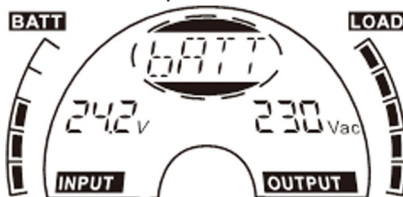
Рисунок 6.2 Режим работы от аккумулятора
