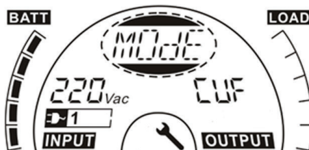
Шаг 6: “CVF” мигает после нажатия кнопки Выбор. Нажмите кнопку Ввод Короткое касание кнопки Ввод для выхода из режима настройки.
