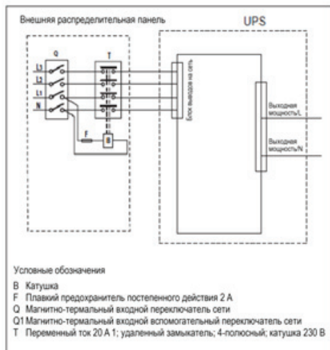
Рис. 6-5 Модель 10 кВА Компакт и внешнее изолирующее устройство
