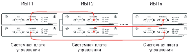
Рисунок 34 – Схема подключения нескольких системных шасси в параллельный режим
