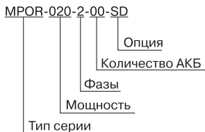
Рисунок 1 – Структура обозначения ИБП
