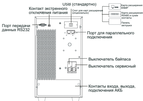
Рисунок 7 – Внешний вид задней панели ИБП на 6 кВА / 10 кВА типа MPOT110 с увеличенным временем работы
