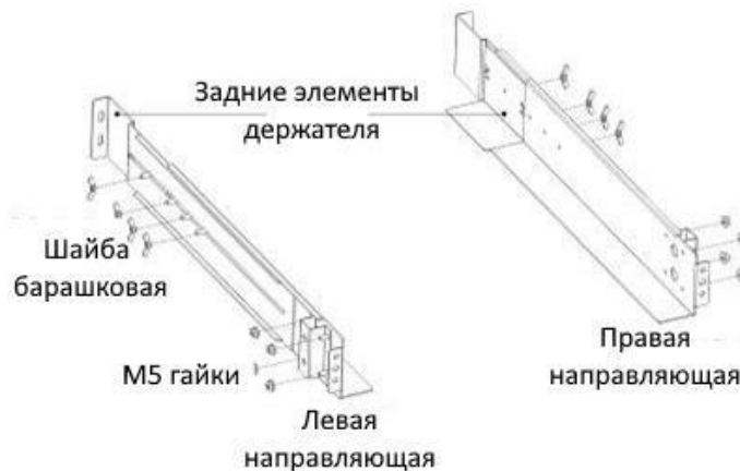
Рисунок 3-3. Крепление монтажного комплекта рельс
