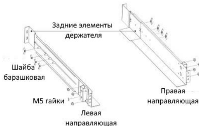
Рисунок 2-4. Крепление монтажного комплекта рельс
